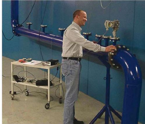
Am system-Prüfstand wird der Einfluss verkürzter Einlaufstrecken auf die deltaflow ermittelt.
